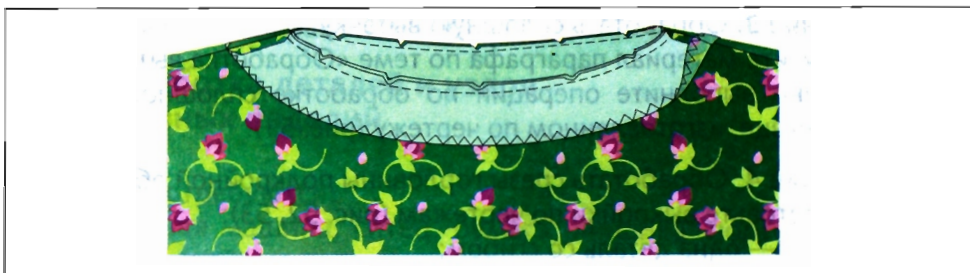
Рис. 54. Обработка среза горловины обтачкой
