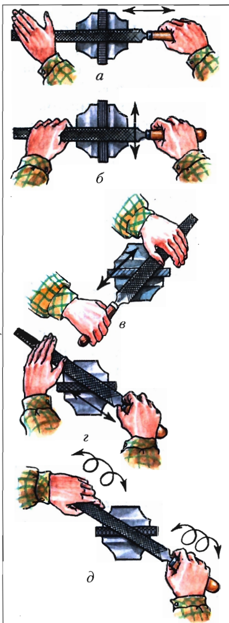
Рис. 138. Приёмы опиливания напильником
