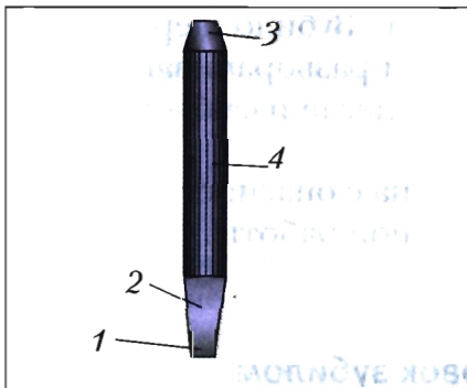
Рис. 130. Зубило: 1 — режущая кромка, 2 — боковая поверхность лезвия, 3 — ударная часть, 4 — стержень
