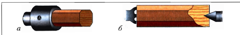
Рис. 113. Крепление детали: а – в патроне винтом, б – трезубцем с поджатием конусом задней бабки
