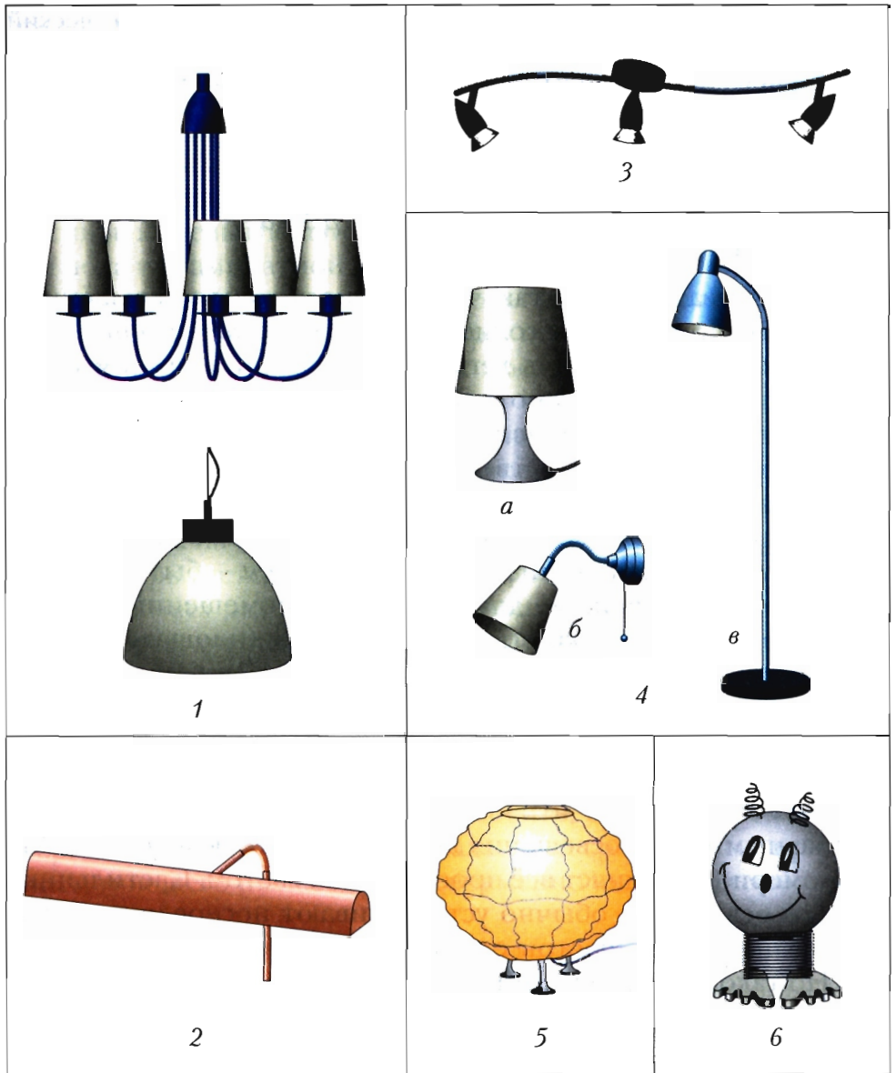
Рис. 77. Светильники разных типов освещения: 1 – общего; 2 – направленного; 3 – комбинированного; 4 – местного ( a – настольная лампа, б – бра, в – торшер); 5 – светильник-ночник; 6 – декоративный светильник
