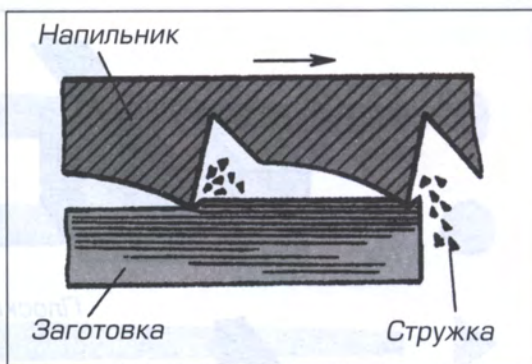
Рис. 185. Процесс работы напильника
