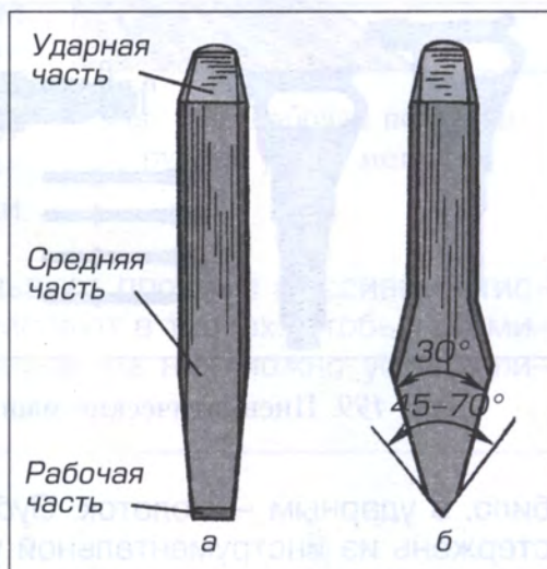
Рис. 196. Зубило (а) и крейцмейсель (б)
